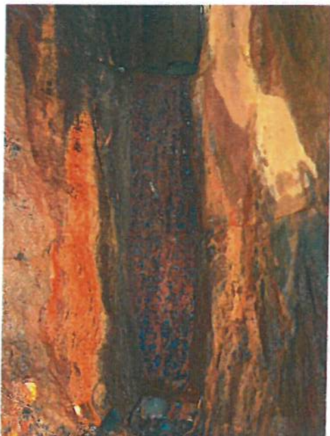
Bilde over, Skram C: Skrambredde: 0,17[m] Skramhøyde: 0,9[m] Plassering: Toppen av skram, 9høydemeter under starten av etappe.
