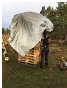
Foto 3-6: Gjennomføringen av test, tildekking av en altertavle mock-up. «Altertavlen» var 265 cm høy. Foto: Lundberg, Østre Agder Brannvesen.
