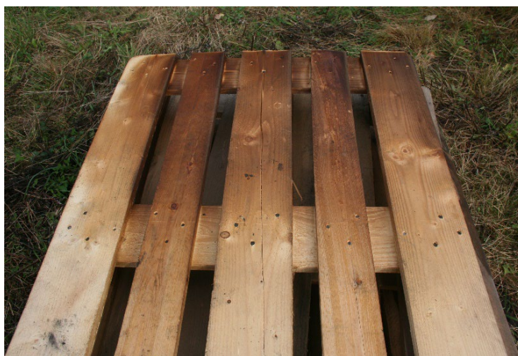
Foto 12: Resultat fra test 1a, varmeskadet trepall.
