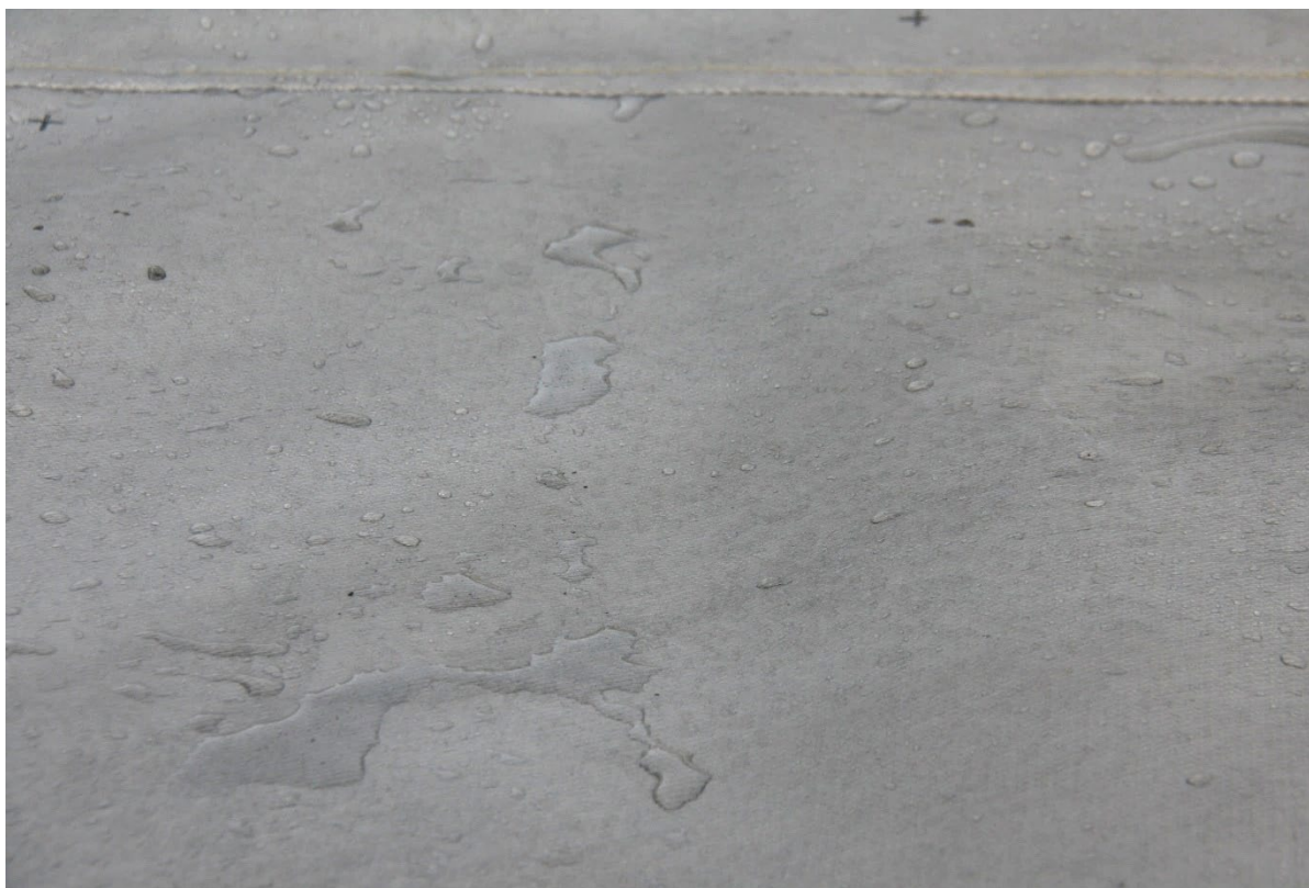
Foto 13: Resultat fra test 6 der vanddråpene preller av overflaten etter brann- og vanntest.
