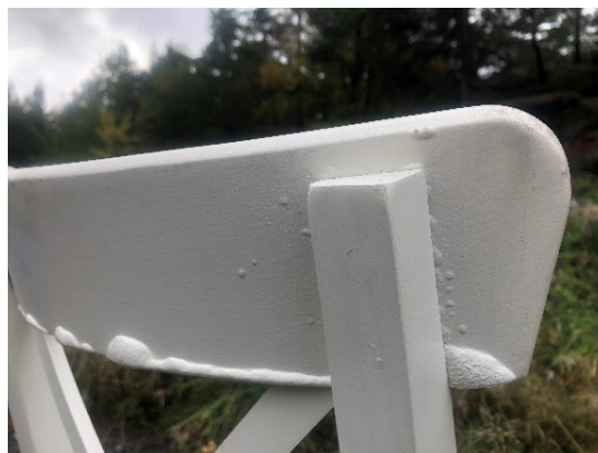
Foto 8: Resultat fra test 4: fuktskader på stolens bakside.
