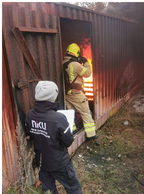
Foto 16: Bruk av IR kamera underveis i testen for å sjekke overflatetemperaturer. NIKU noterer underveis. Arendal. Foto: Neil Blendford, ØABV.
