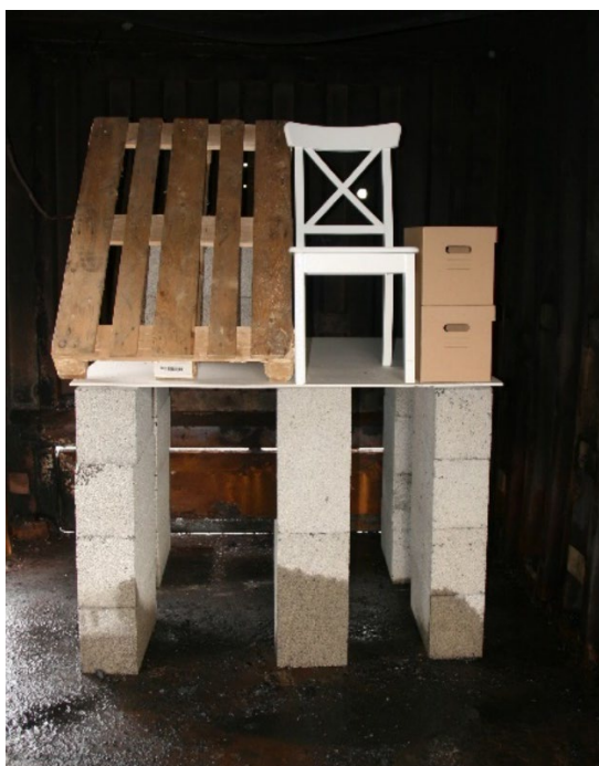
Foto 1 og 2: Oppsett fra test-gjennomføringen, utildekket og tildekket før branntesten. Foto: Kjølisen Jernæs, NIKU.
