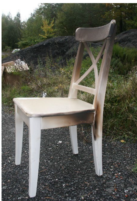
Foto 11: Resultat fra test 1a, varmeskadet stol.
