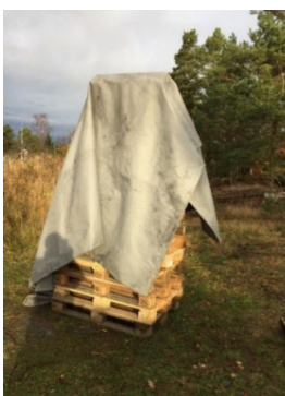
Foto 3-6: Gjennomføringen av test, tildekking av en altertavle mock-up. «Altertavlen» var 265 cm høy. Foto: Lundberg, Østre Agder Brannvesen.
