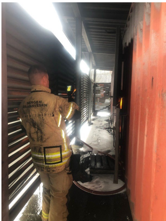
Foto 15: Bruk av IR kamera underveis i testen for å sjekke overflatetemperaturer. Bergen brannvesen.
