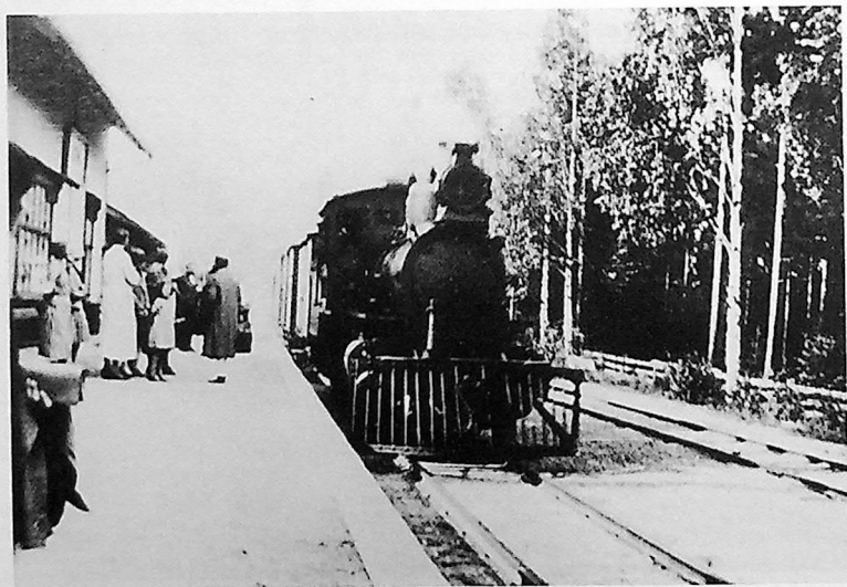
Et bilde fra smalsporets siste år. Loket ser ut til å være av type XXIII d (nr. 51,52 og 76-79). Som man ser er loket utstyrt med en snodig variant av en "Kufanger". Atna st.(?)
