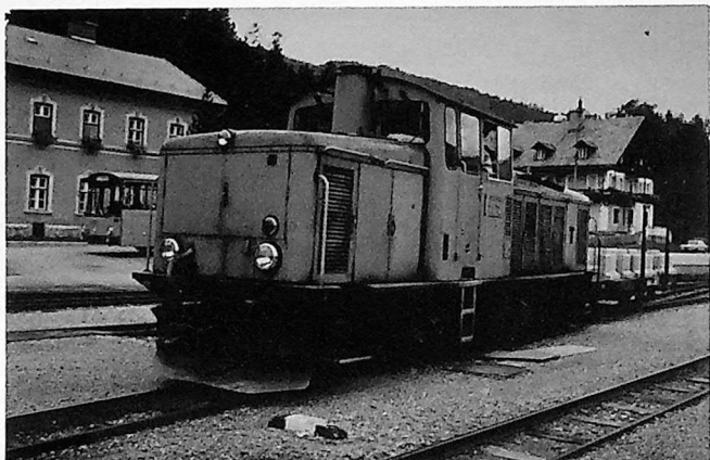
St.L.B. VL 12, bygget 1966. Lokene er diesel- elektriske med aks.f. Bo'Bo'. Foto i Murau- Stolzalpe.
