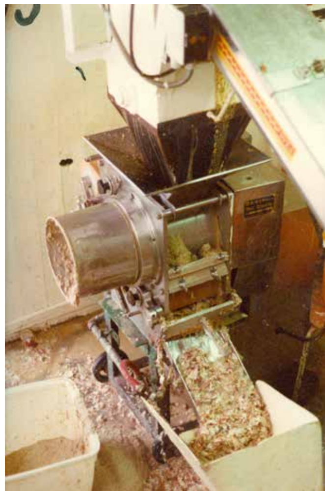
«Bibun»-maskina som kom på 1970-tallet, erstatta noen av renskeoperasjoene. Den maste krabbekjøttet til en masse. Rensking av klør måtte fremdeles gjøres for hånd. Foto: Tove Boneng.
