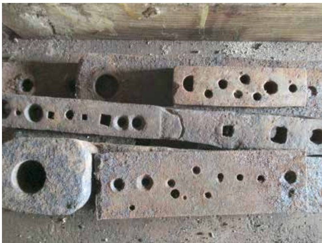
Smidde verktøy til å lage hode på spiker og bolter – spikerlo – funnet i den blå gamle kassa.
