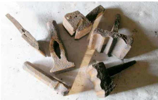
Forskjellige undersett m.m. til å sette i hullene i ambolten for å forme smijernet.
