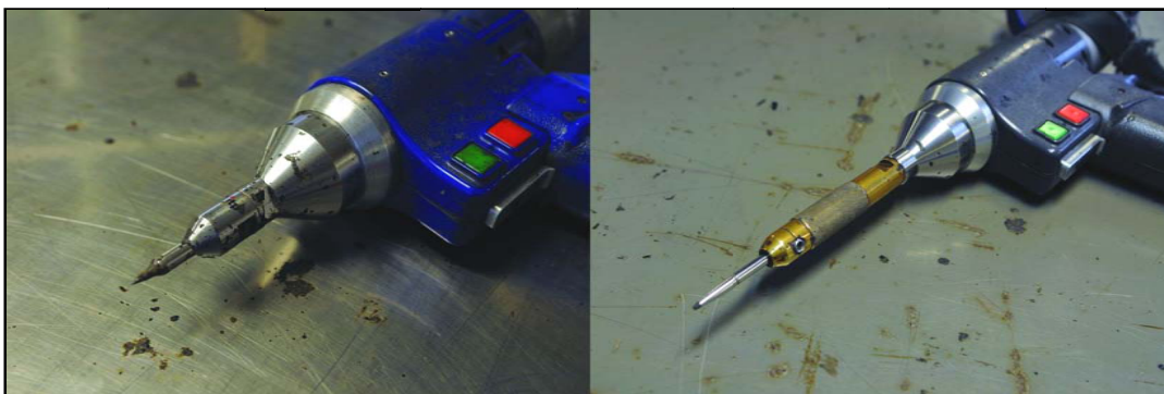
Figur 4 Målespiss. T.v. Carbide point probe (original FARO-probe), og t.h. spesialtilpasset målespiss med PDA-penn.
