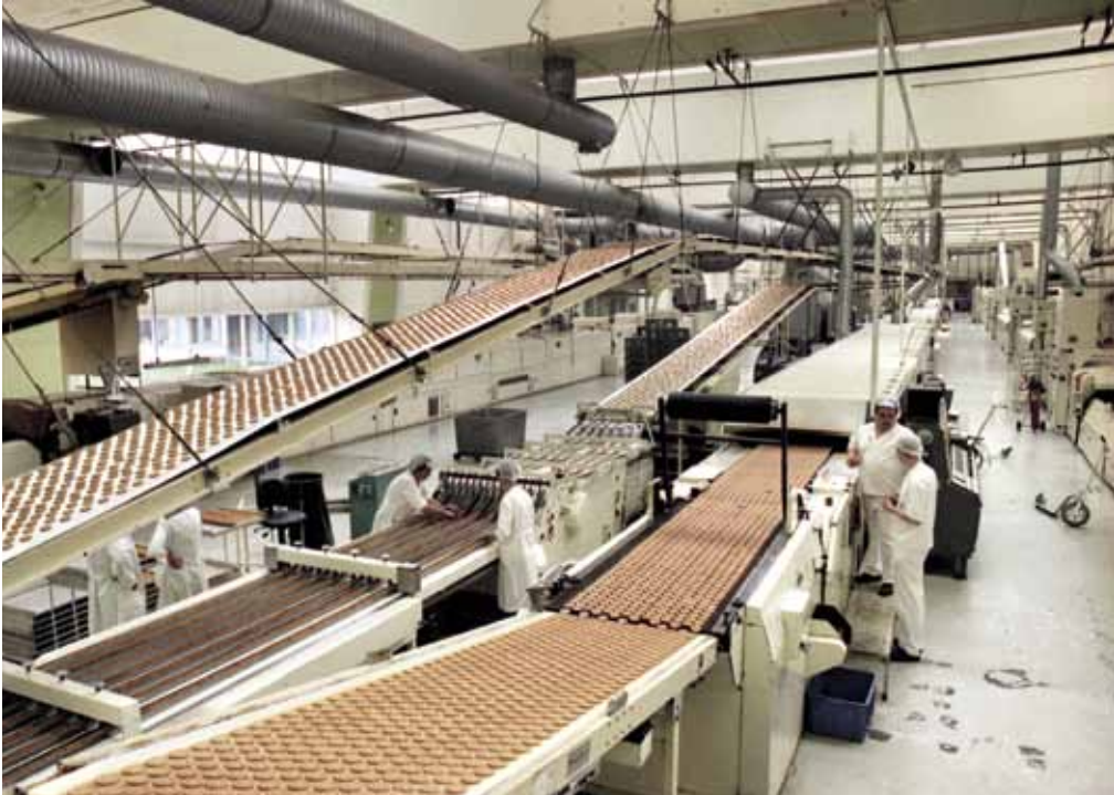
Samlebåndene løper gjennom hele fabrikkens i flere plan. Bakerne kvalitetssjekker kjeksene som er stekt i D-ovnen, før den føres videre på kjølebåndet. Pakkerne kontrollerer at kjeksene legger seg riktig opp i stackeren før den går til pakkemaskinen. FOTO: RODERICK T. EWART/AKERSHUSMUSEET
