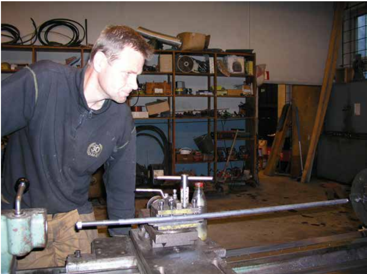
Haakon Skoglunn skruer et stag fast i dreiebenken (over) og monterer det inn i skjærehodet (under).
