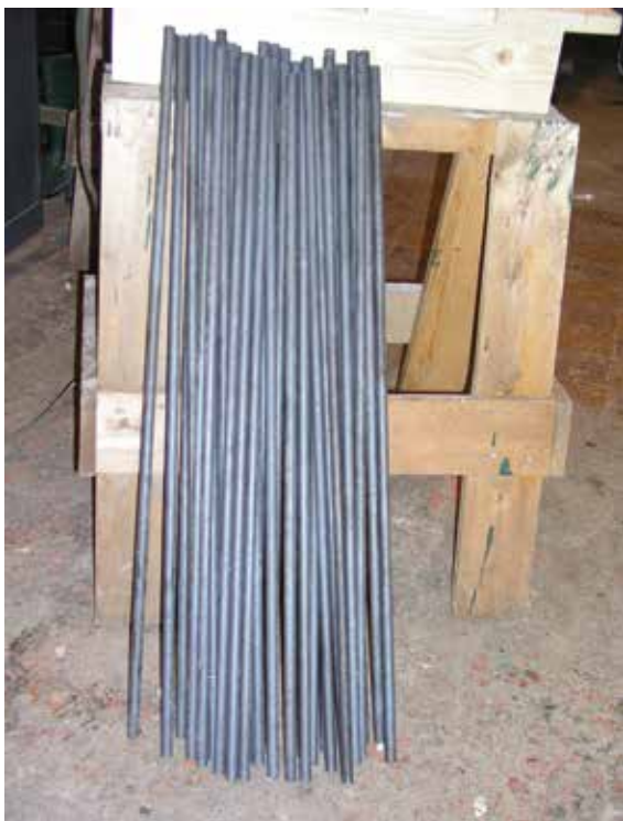
Rundstål, 16 mm i diameter, som skal brukes til stag, kappes i lengder av Bjørn Sundbakken.
