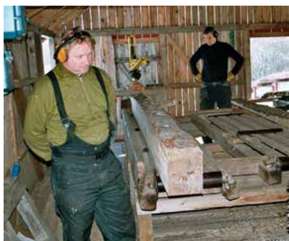
7 Stokken kommer ut fra kløvsaga. Tre sider er nå skåret. Med dette er flåstokken ferdigbehandlet på saga.
