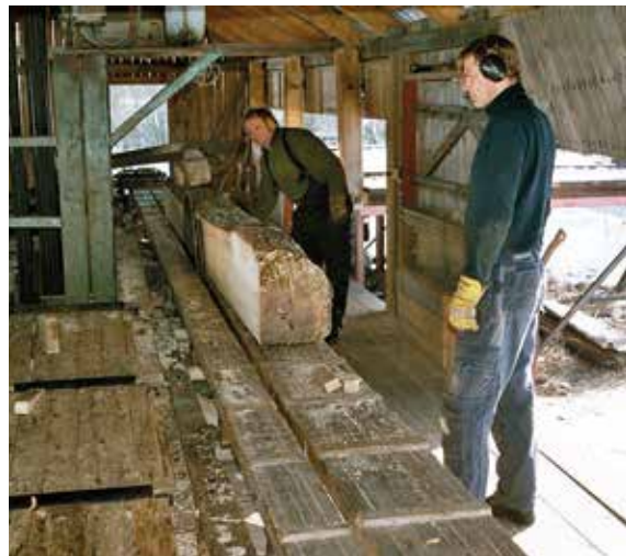
5 To sider av stokken er ferdigskåret på kantsaga. Stokken løftes så over til kløvsaga.
