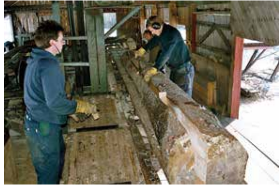
4 En bakhun skjæres av stokken. Trekiler slås inn i sagsporet.
