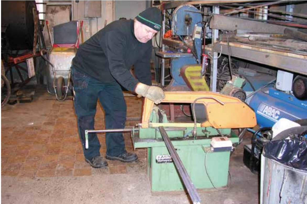
Rundstål, 16 mm i diameter, som skal brukes til stag, kappes i lengder av Bjørn Sundbakken.
