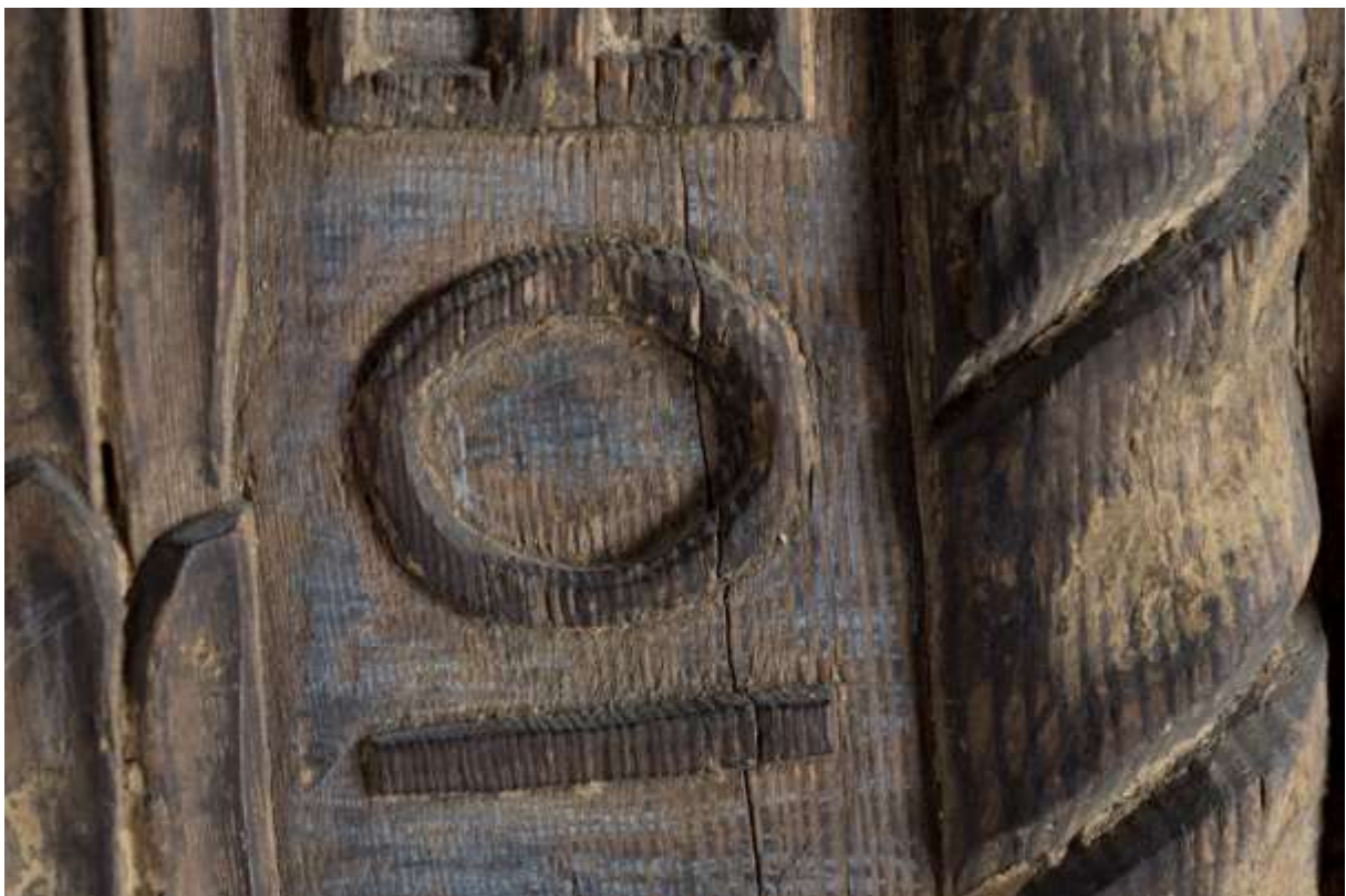
På bilderna ovan kan man se att gjutmodellen varit bemålad. Det finns rester av röd färg och kredering på översta bilden, blå färg och kredering på bilden nedan.
