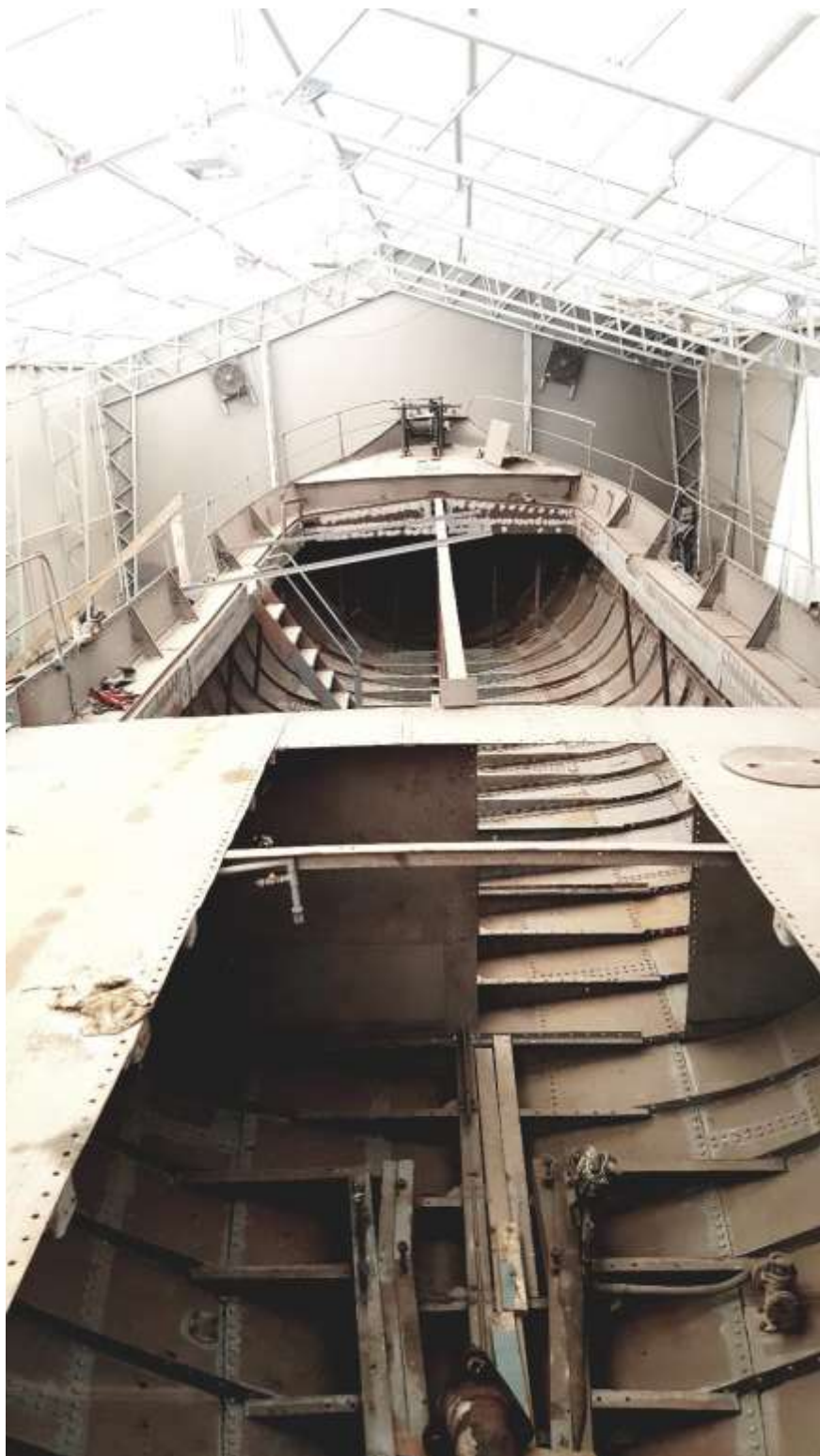
M/S Brandbu sept. 2017. Alle plater under F-gangen ferdigstilt. Gjenstår noe lekkasjetesting og sveising av groprust før overflatebehandling.
