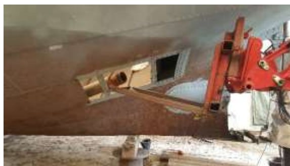
Propellhylsen ble tatt ut, rengjort og lagt tilbake mens det var god tilgang til maskinrom. God dialog med Italo fra BDF gjør planlegging av dugnad enkelt.
