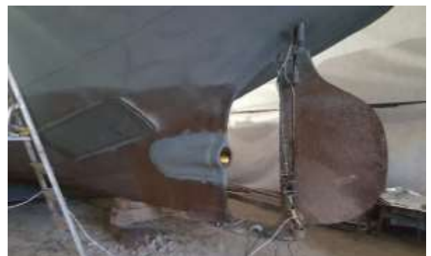
Ferdigstilt hylseplater og plate C BB spt 2-3. Sept.17
