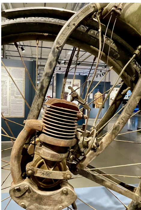
ÖWA hjelpemotor fra 1922 montert på sykkel. (Foto: Åsmund J. Sletten/Norsk vegmuseum, Sta- stens vegvesen)
